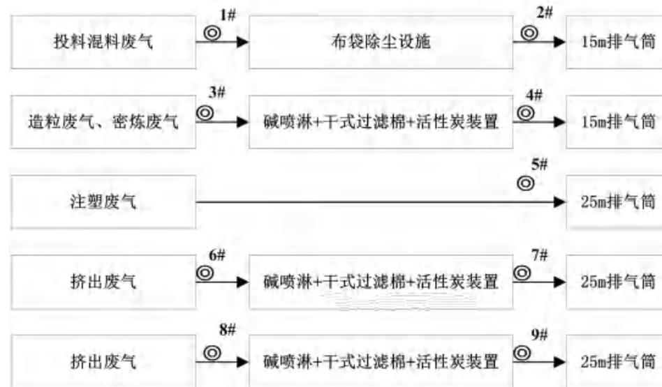
图 3.1-1 废气处理工艺流程及监测点位（注 ⊙ 废气监测点位）
