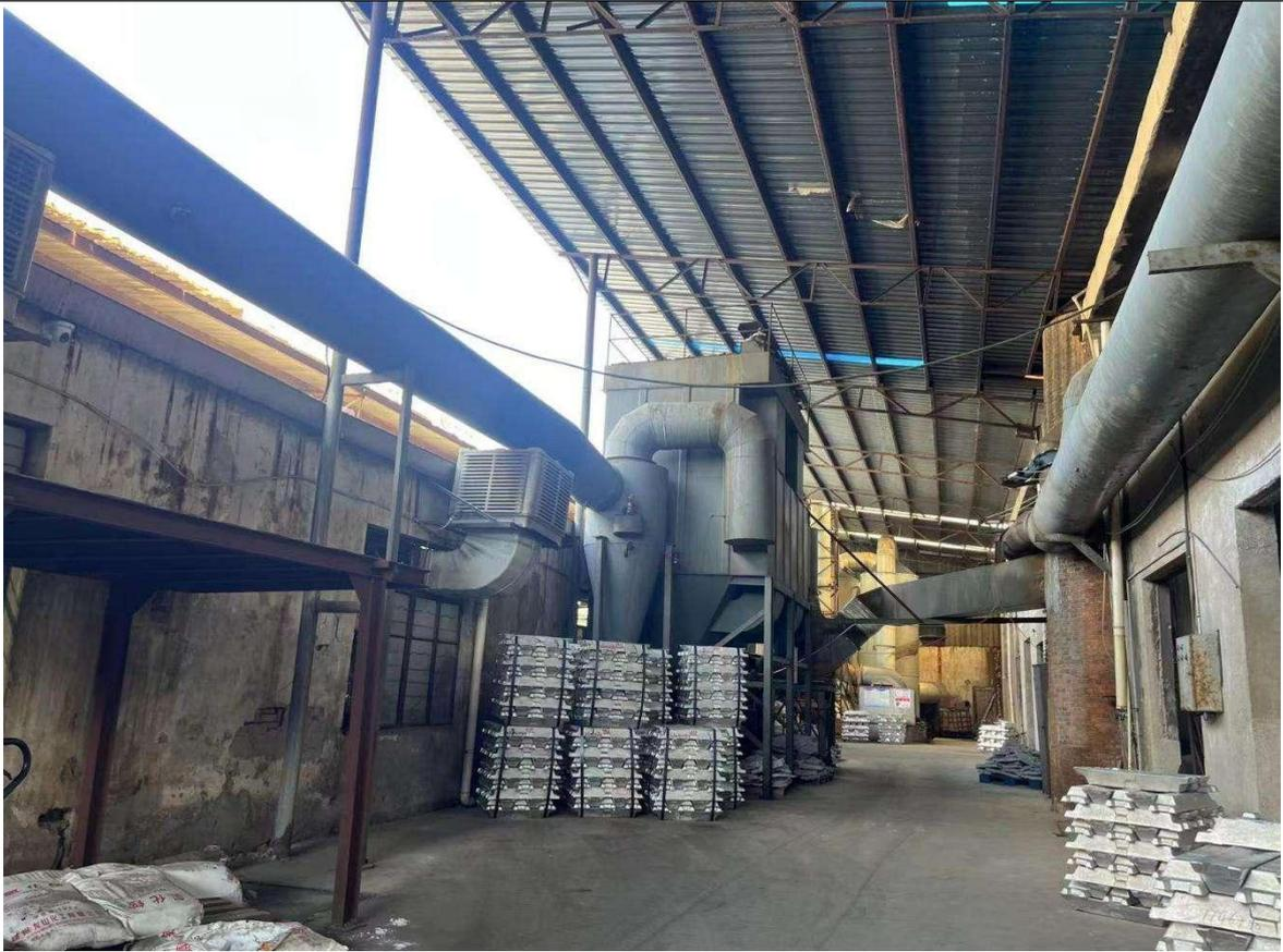
铸造废气（抽丝炉）、熔化废气（抽丝炉）、燃料废气（抽丝炉）治理设施
