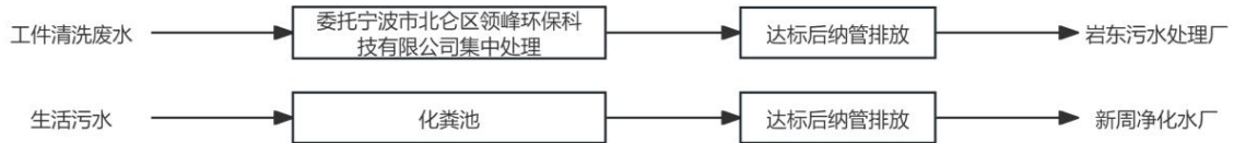
图3-2 项目废水处理及排放流程图
