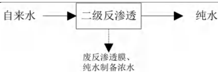
图 2.3-7 纯水制备生产工艺流程图及产污环节图
