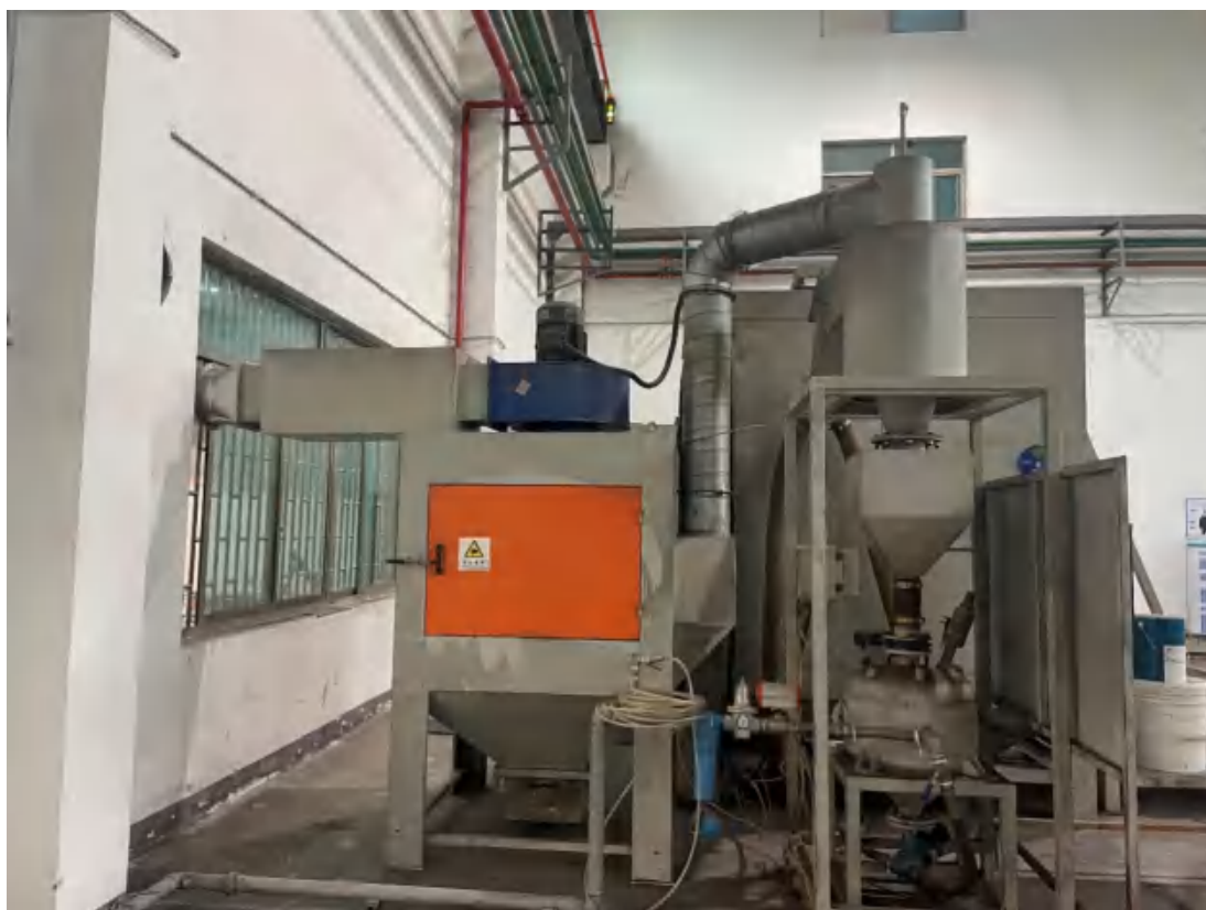
图3.1-5 喷砂废气处理设施示意图
